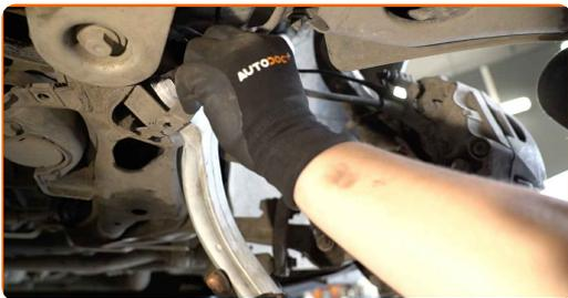
**14** Verbinden Sie das Kugelgelenk mit dem Achsschenkel.
