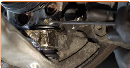
**17** Schrauben Sie die hintere Armbefestigung an. Verwenden Sie Ring-Gabelschlüssel Nr. 18 (2 Teile).
