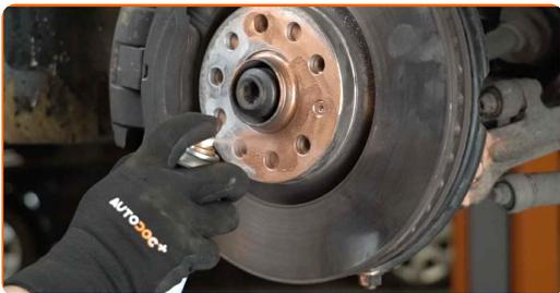
**25** Die Bremsscheibenoberfläche reinigen. Benutzen Sie einen Bremsenreiniger.
