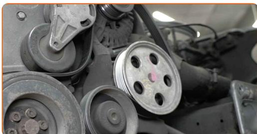
**5** Entfernen Sie den Keilrippenriemen.
