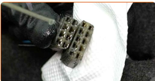
**39** Bringen Sie die Steckverbinder des elektrischen Fensterhebers an der Steuereinheit an.
