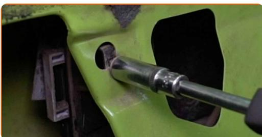
**18** Ziehen Sie die Steckverbindung aus dem Motor des elektrischen Fensterhebers.
