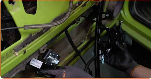
**25** Schrauben Sie die Befestigungen des Fensterhebermechanismus an. Verwenden Sie Stecknuss Nr. 10. Verwenden Sie einen Ratschenschlüssel.
