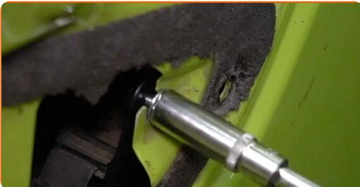
**26** Schließen Sie die Steckverbindung an den Motor des elektrischen Fensterhebers an.
