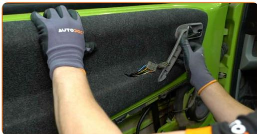
**36** Schrauben Sie die Befestigungen des Türgriffs fest. Verwenden Sie einen Kreuzschlitzschraubendreher.
