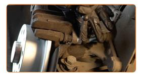
Entfernen Sie den Bremssattel.
