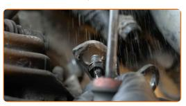
Schrauben Sie die Befestigung des Bremssattels ab. Verwenden Sie Ring-Gabelschlüssel Nr. 13. Verwenden Sie Ring-Gabelschlüssel Nr. 15.
