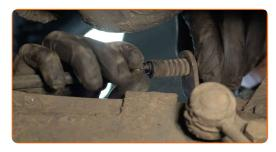
Reinigen Sie den Bereich, an dem der Bremsschlauch mit dem Bremssattel und der Bremskreisleitung verbunden ist. Benutzen Sie eine Drahtbürste. Benutzen Sie WD-40-Spray.
