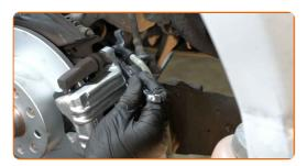
Entlüften Sie das Bremssattelsystem. Ohne das Starten des Motors drücken Sie das Bremspedal mehrmals, bis Sie signifikanten Widerstand spüren.
