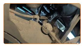
9 Entfernen Sie das Handbremsseil. Verwenden Sie eine Wasserpumpenzange.
