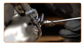
Bringen Sie die Halteklammer des Bremsschlauchs an. Verwenden Sie einen Gummi-Hammer.
