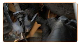
Ziehen Sie die Bremssattelbefestigungen fest. Verwenden Sie Stecknuss Nr. 13. Verwenden Sie einen Drehmomentschlüssel. Ziehen Sie ihn mit 35 Nm Drehmoment fest.
