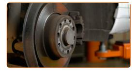
Reinigen Sie die Feststellbremshalterung. Benutzen Sie eine Drahtbürste. Benutzen Sie WD-40-Spray.
