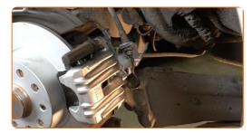
Entfernen Sie die Bremsschlauchklemmen.
