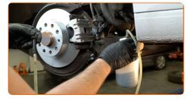
Entfernen Sie den Schmutz von der Schraube zur Befestigung des Bremsschlauchs. Benutzen Sie einen Bremsenreiniger.
