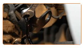
Lockern Sie das Befestigungselement, das die Bremsleitung mit dem Bremssattel verbindet. Verwenden Sie Ring-Gabelschlüssel Nr. 11.
