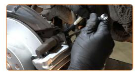
Trennen Sie den Schlauch des Bremsentlüftungs-Kits.
