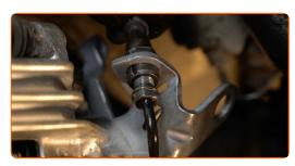
Drehen Sie das Befestigungselement ein, das die Bremsleitung mit dem Bremsschlauch verbindet. Verwenden Sie Ring-Gabelschlüssel Nr. 11.
