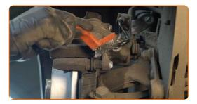
Klemmen Sie den Bremsschlauch ab, indem Sie eine geeignete Klemme einsetzen.
