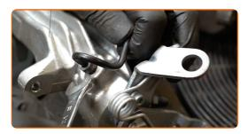
Installieren Sie den Bremssattel und fixieren Sie diesen. Verwenden Sie Ring-Gabelschlüssel Nr. 13. Verwenden Sie Ring-Gabelschlüssel Nr. 15.
