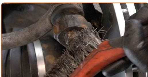
**9** Lösen Sie das Ende der Befestigungsmutter an dem Achsschenkel. Verwenden Sie Stecknuss Nr. 18. Verwenden Sie einen Ratschenschlüssel.
