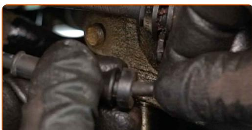
**12** Lösen Sie den Bremsschlauch vom Federbein.
