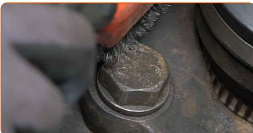
**16** Lösen Sie die Befestigung der Sattelhalterung. Verwenden Sie Stecknuss Nr. 27. Verwenden Sie einen Ratschenschlüssel.
