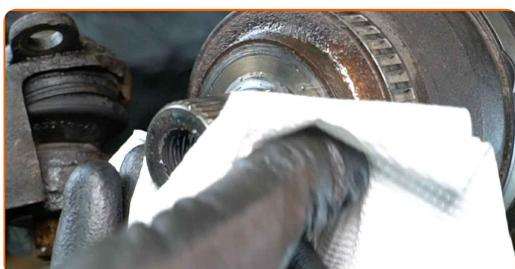
**48** Behandeln Sie die Keilwellen des Antriebswellen-Gleichlaufgelenks. Benutzen Sie ein Kupferschmiermittel.
