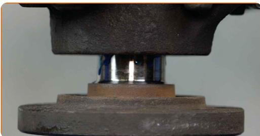
**46** Reinigen Sie die Anbringungssitze des Federbeins. Benutzen Sie eine Drahtbürste. Benutzen Sie WD-40-Spray.
