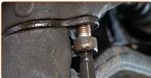
**61** Reinigen Sie die Nabe. Benutzen Sie eine Drahtbürste. Verwenden Sie Allzweckreinigungsspray.
