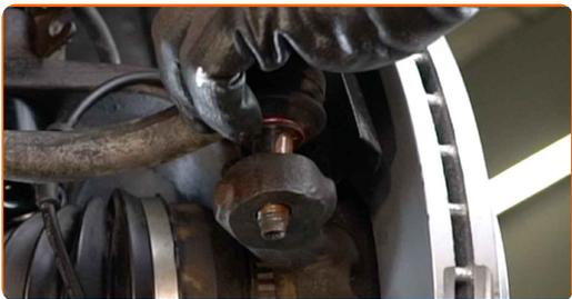
**70** Schrauben Sie die Befestigungsmutter auf, die den Spurstangenkopf mit dem Achsschenkel verbindet. Verwenden Sie Stecknuss Nr. 18. Verwenden Sie einen Ratschenschlüssel.
