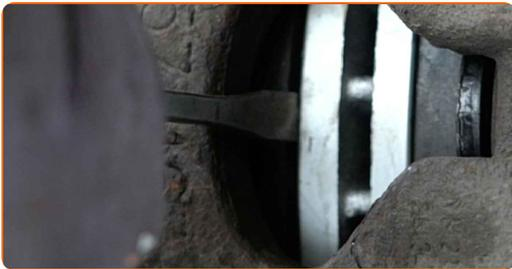
**15** Die Befestigungselemente der Bremssattelhalterung reinigen. Benutzen Sie eine Drahtbürste. Benutzen Sie WD-40-Spray.
