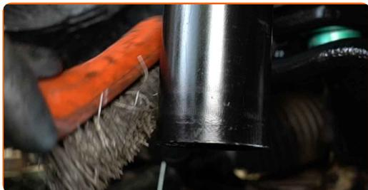
**47** Die Keilwellen des CV-Gelenks der Antriebswelle reinigen. Benutzen Sie eine Drahtbürste. Benutzen Sie WD-40-Spray.
