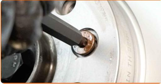
**65** Ziehen Sie die Befestigung der Bremsscheibe fest. Verwenden Sie Inbusschlüssel Nr. H7. Verwenden Sie einen Drehmomentschlüssel. Ziehen Sie ihn mit 10 Nm Drehmoment fest.
