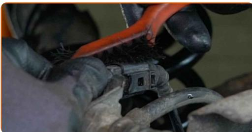
**9** Trennen Sie den Steckverbinder des Verschleißsensors des Bremsbelags.
