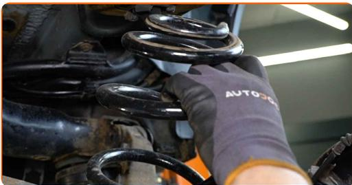
**16** Entfernen Sie die Gummilager der Feder.
