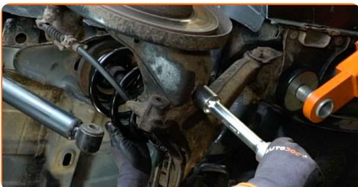
**20** Reinigen Sie die Montagesitze des Stabilisators. Benutzen Sie eine Drahtbürste. Benutzen Sie WD-40-Spray.
