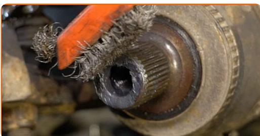
**61** Behandeln Sie die Keilwellen des Antriebswellen-Gleichlaufgelenks. Benutzen Sie ein Kupferschmiermittel.
