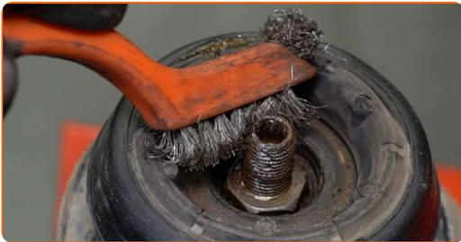
**43** Entfernen Sie die Stangenmutter des Federkolben. Verwenden Sie eine 21 mm Schienenmutterstecknuss. Verwenden Sie Inbusschlüssel Nr. H7. Verwenden Sie einen Ratschenschlüssel.
