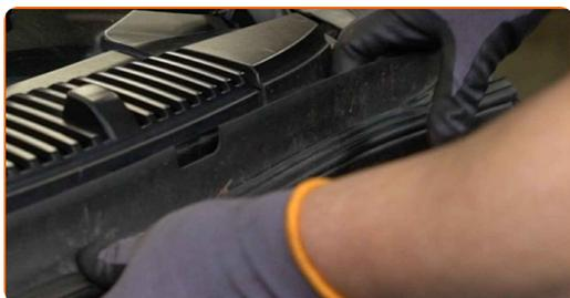
**5** Schrauben Sie die Befestigung der Kunststoffplatte ab. Verwenden Sie Stecknuss Nr. 10. Verwenden Sie einen Ratschenschlüssel.
