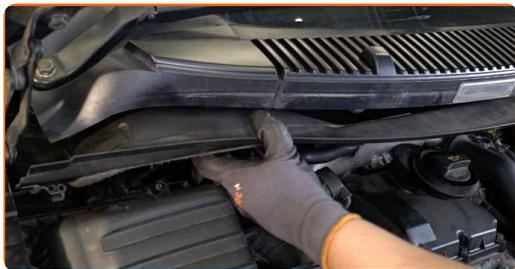
**97** Schrauben Sie die Befestigung der Kunststoffplatte an. Verwenden Sie Stecknuss Nr. 10. Verwenden Sie einen Ratschenschlüssel.
