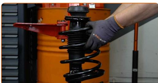
**58** Reinigen Sie die Anbringungssitze des Federbeins. Benutzen Sie eine Drahtbürste. Benutzen Sie WD-40-Spray.
