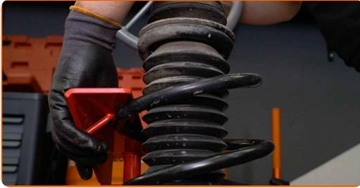
**42** Reinigen Sie die Kolbenstange des Federbeins. Benutzen Sie eine Drahtbürste. Benutzen Sie WD-40-Spray.
