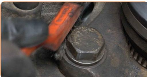
**22** Lösen Sie die Befestigung der Sattelhalterung. Verwenden Sie Stecknuss Nr. 27. Verwenden Sie einen Ratschenschlüssel.
