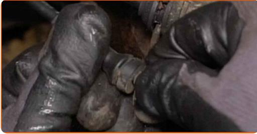
**19** Lösen Sie den Bremsschlauch vom Federbein.
