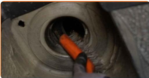
**59** Reinigen Sie die Befestigungen, die das Kugelgelenk mit dem Achsschenkel verbinden. Benutzen Sie eine Drahtbürste. Benutzen Sie WD-40-Spray.
