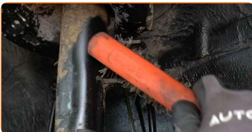
**16** Schrauben Sie das Befestigungselement heraus, das die Druckstange mit dem Federbein verbindet. Verwenden Sie Ring-Gabelschlüssel Nr. 16. Verwenden Sie Stecknuss Nr. 19. Verwenden Sie einen Ratschenschlüssel.
