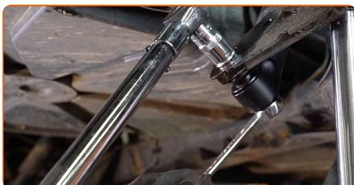
**22** Die Montage unter dem Hinterachsträger entfernen.
