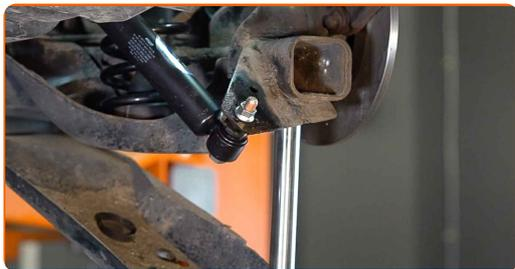
**21** Ziehen Sie den unteren Befestiger des Stoßdämpfers an. Verwenden Sie Ring-Gabelschlüssel Nr. 18. Verwenden Sie Stecknuss Nr. 18. Verwenden Sie einen Drehmomentschlüssel. Ziehen Sie ihn mit 105 Nm Drehmoment fest.
