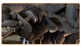
Installieren Sie den Bremssattel und fixieren Sie diesen. Verwenden Sie Stecknuss Nr. 13. Verwenden Sie einen Drehmomentschlüssel. Ziehen Sie ihn mit 32 Nm Drehmoment fest.
