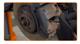
Entfernen Sie den Bremssattel.
