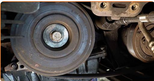
**12** Entfernen Sie den Keilrippenriemen.
