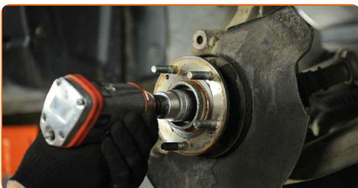
**13** Entfernen Sie die Befestigungsmutter.
