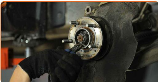
**12** Schrauben Sie die Nabenmutter ab. Verwenden Sie Stecknuss Nr. 32. Verwenden Sie einen Ratschenschlüssel.
