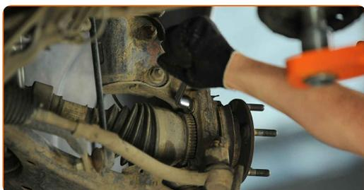
**19** Entfernen Sie die Befestigungsschrauben.
