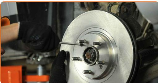
**11** Entfernen Sie den Splint, der die Nabenmutter sichert. Verwenden Sie eine Kneifzange.
