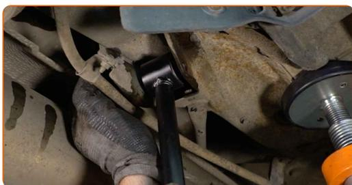
**Austausch: unterer Längslenker der Hinterachse – Lexus RX XU30. Tipp:**
