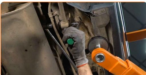
**11** Entfernen Sie die Befestigungsschrauben.
