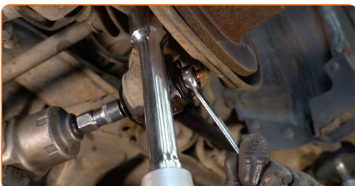
**18** Ziehen Sie das Befestigungselement an, das den Längslenker mit der Karosserie verbindet. Verwenden Sie Ring-Gabelschlüssel Nr. 17. Verwenden Sie Stecknuss Nr. 17. Verwenden Sie ein Windeisen.
