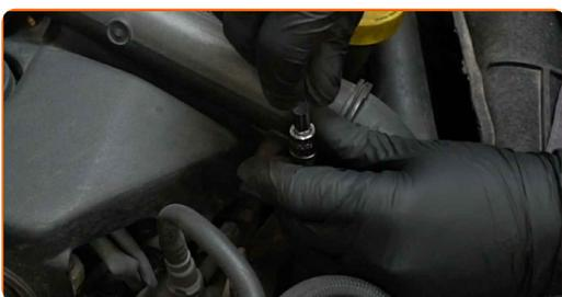
**4** Lösen Sie die Luftansaugschlauchklemme. Verwenden Sie Kombinationszangen. Benutzen Sie ein Brecheisen.
