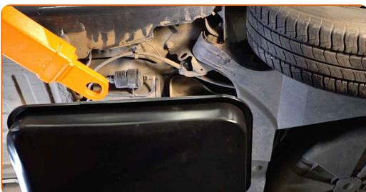
**4** Drücken Sie die Clips zusammen und lösen Sie die Kraftstoffzufuhrleitungen vom Kraftstofffiltergehäuse. Verwenden Sie Kraftstoffleitungszangen.
