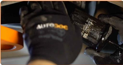
**6** Installieren Sie einen neuen Kraftstofffilter.
