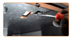
Entfernen Sie die seitliche Abdeckung des Armaturenbretts.
