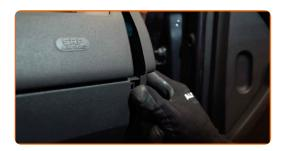
Bringen Sie die Seitenverkleidung an. Positionieren Sie das Teil, indem Sie die Führungen verwenden und verschließen Sie die Verbindungselemente.
