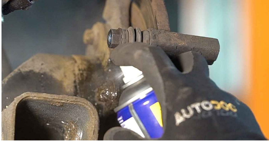
14 Lösen Sie die Befestigung der Sattelhalterung. Verwenden Sie Stecknuss Nr. E16. Verwenden Sie ein Windeisen.
