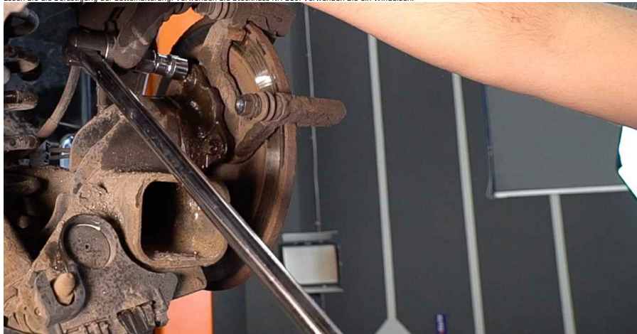
15 Entfernen Sie die Sattelhalterung.
