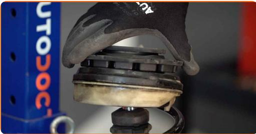
**33** Ziehen Sie die Federbeinkolbenstangenmutter an. Verwenden Sie Inbusschlüssel Nr. H6. Verwenden Sie Ring-Gabelschlüssel Nr. 18. Verwenden Sie einen Drehmomentschlüssel. Ziehen Sie ihn mit 62 Nm Drehmoment fest.
