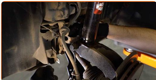
**44** Befestigen Sie die Stabilisatorverbindung am Federbein. Verwenden Sie Inbusschlüssel Nr. H6. Verwenden Sie Ring-Gabelschlüssel Nr. 17. Verwenden Sie einen Drehmomentschlüssel. Ziehen Sie ihn mit 44 Nm Drehmoment fest.
