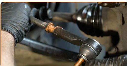
Austausch: Spurstangenkopf – RENAULT Megane I Kasten / Kombi (KA\_).
