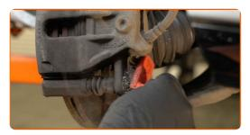
Schrauben Sie die Befestigung des Bremssattels ab. Verwenden Sie Ring-Gabelschlüssel Nr. 13. Verwenden Sie Ring-Gabelschlüssel Nr. 19.
