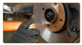
Die Bremsscheibenoberfläche reinigen. Benutzen Sie einen Bremsenreiniger.
