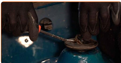
**4** Lösen Sie die oberen Befestigungselemente des Federbeinstützlagers. Verwenden Sie Ring-Gabelschlüssel Nr. 21. Verwenden Sie Inbusschlüssel Nr. H6. Verwenden Sie einen Ratschenschlüssel.
