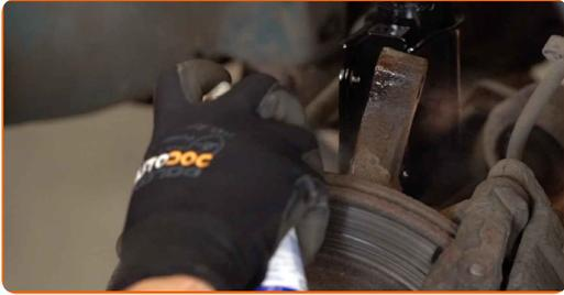
**35** Befestigen Sie das Dämpferbein auf dem Achsschenkel.
