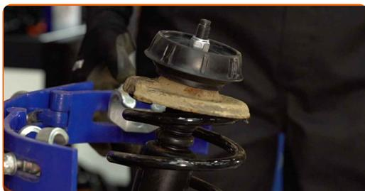
**31** Entfernen Sie das zusammengebaute Federbein.
