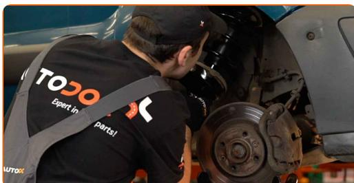
**33** Ziehen Sie die obere Befestigungsmutter des Dämpferbeins heraus. Schrauben Sie diese nicht fest.
