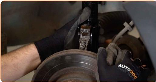
**36** Bringen Sie die neuen Schrauben des Achsschenkels an und ziehen Sie sie an. Verwenden Sie Stecknuss Nr. 21. Verwenden Sie Ring-Gabelschlüssel Nr. 21. Verwenden Sie einen Drehmomentschlüssel. Ziehen Sie ihn mit 140 Nm Drehmoment fest.
