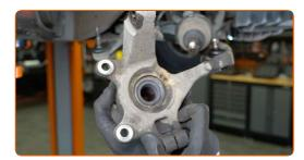
Entfernen Sie die Radnabe vom Achsschenkel. Verwenden Sie einen Druckstücksatz mit Ein-/Auspresswerkzeug.
