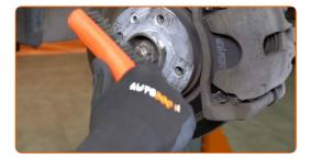
Lösen Sie das Befestigungselement, welches die Antriebswelle mit der Radnabe verbindet. Verwenden Sie Stecknuss Nr. 30. Verwenden Sie ein Windeisen.
