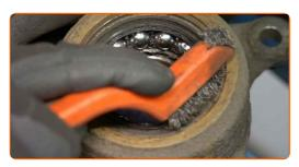
Entfernen Sie den Sicherungsring am Radnabenlager. Verwenden Sie einen flachen Schraubendreher.
