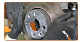
Reinigen Sie die Befestigung des ABS-Sensors. Verwenden Sie eine Nylon-Reinigungsbürste. Verwenden Sie Allzweckreinigungsspray.
