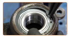
Montieren Sie die Radnabe auf dem Achsschenkel. Verwenden Sie einen Druckstücksatz mit Ein-/Auspresswerkzeug.
