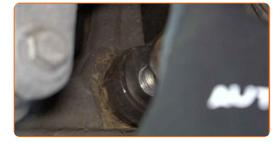
Ziehen Sie die Befestigungen des Bremssattelhalters fest. Verwenden Sie Stecknuss Nr. 17. Verwenden Sie einen Drehmomentschlüssel. Ziehen Sie ihn mit 105 Nm Drehmoment fest.
