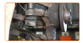
Ziehen Sie die Befestigungen an, die das Kugelgelenk des unteren Querlenkers mit dem Achsschenkel vebinden. Verwenden Sie Ring-Gabelschlüssel Nr. 16. Verwenden Sie Stecknuss Nr. 16. Verwenden Sie einen Drehmomentschlüssel. Ziehen Sie ihn mit 37 Nm Drehmoment fest.
