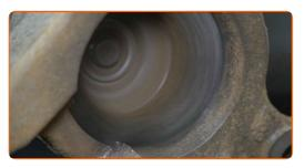
Montieren Sie einen neuen ABS-Sensorhalter.
