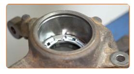
Drücken Sie das neue Lager in den Achsschenkel. Verwenden Sie einen Druckstücksatz mit Ein-/Auspresswerkzeug.
