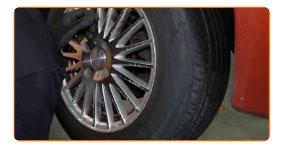
Reinigen Sie das Befestigungselement der Antriebswelle. Benutzen Sie eine Drahtbürste. Benutzen Sie WD-40-Spray.
