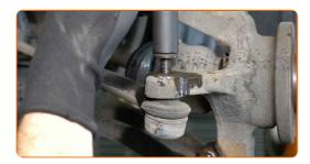
Lösen Sie den Spurstangenkopf vom Achsschenkel. Verwenden Sie einen Kugelgelenkabzieher.
