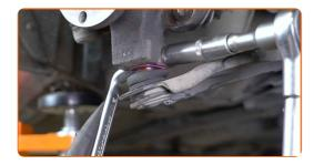
Ziehen Sie die unteren Befestigungen an, die das Federbein mit dem Achsschenkel verbinden. Verwenden Sie Ring-Gabelschlüssel Nr. 17. Verwenden Sie Stecknuss Nr. 18. Verwenden Sie einen Drehmomentschlüssel. Ziehen Sie ihn mit 116 Nm Drehmoment fest.
