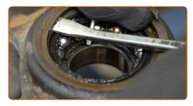
Demontieren Sie den Lagerinnenring, der sich noch auf der Nabe befindet. Verwenden Sie einen Druckstücksatz mit Ein-/Auspresswerkzeug. Verwenden Sie ein ein Trennmesser für Lager.
