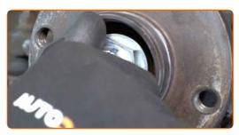
Schrauben Sie die Befestigungen der Antriebswelle an. Verwenden Sie Stecknuss Nr. 30. Verwenden Sie einen Ratschenschlüssel.
