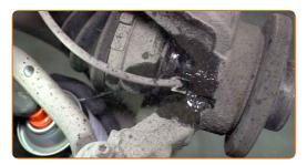
Lösen Sie den ABS-Sensor.
