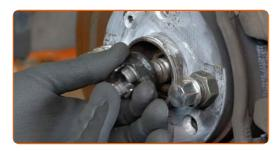
Trennen Sie die Antriebswelle vom Achsschenkel. Verwenden Sie einen Splintentreiber. Benutzen Sie einen Hammer.
