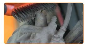
Schrauben Sie die Befestigungen des Bremssattels ab. Verwenden Sie Ring-Gabelschlüssel Nr. 13. Verwenden Sie Ring-Gabelschlüssel Nr. 15.
