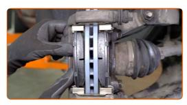
Bauen Sie den Bremssattel ein und befestigen Sie diesen.
