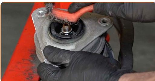
**32** Entfernen Sie die Stangenmutter des Federkolben. Verwenden Sie Inbusschlüssel Nr. H6. Verwenden Sie Stecknuss Nr. 18. Verwenden Sie einen Ratschenschlüssel.
