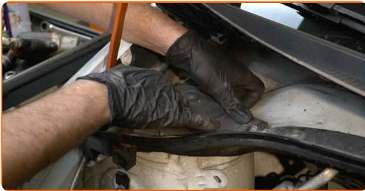
**69** Schrauben Sie die Befestigungen der Abdeckung des Federbeinstützlagers ein. Verwenden Sie Stecknuss Nr. 10. Verwenden Sie einen Ratschenschlüssel.
