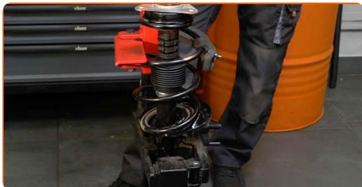
**44** Entfernen Sie das zusammengebaute Federbein.
