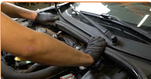
**73** Entfernen Sie die Kotflügel-Abdeckung.
