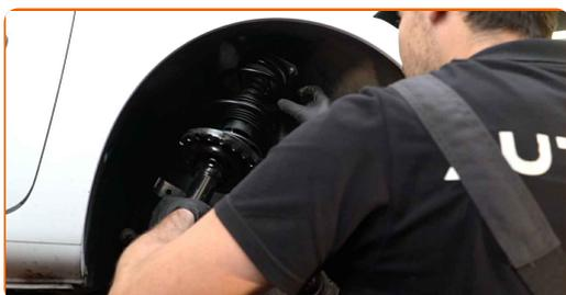
**47** Schrauben Sie die obere Befestigung des Federbeinbefestigung an. Schrauben Sie diese nicht fest.
