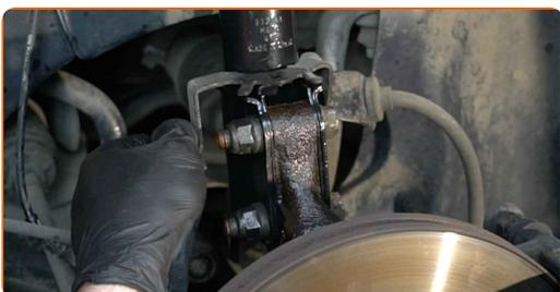
**54** Ziehen Sie die Befestigungsklammer des Bremsschlauchs am Federbein an. Verwenden Sie Stecknuss Nr. 10. Verwenden Sie einen Ratschenschlüssel.
