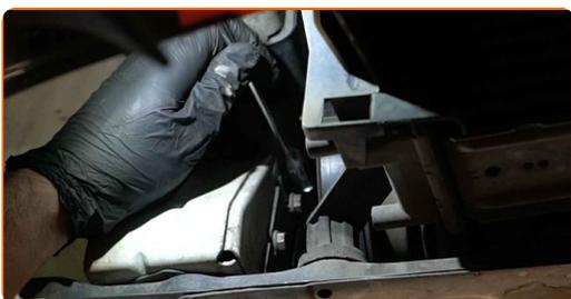
**12** Entfernen Sie den Befestigungswinkel des Kraftstofffilters.
