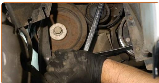
**18** Setzen Sie den Keilrippenriemen auf die Spannrolle auf.
