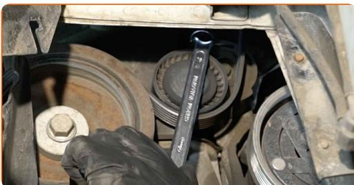
**14** Entfernen Sie den Keilrippenriemen.
