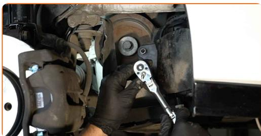
**10** Entfernen Sie den Befestigungswinkel des Kraftstofffilters.
