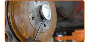
Schrauben Sie die Befestigung der Radnabe ab. Verwenden Sie Stecknuss Nr. 30. Verwenden Sie ein Windeisen.
