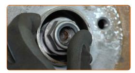
Ziehen Sie die Nabenbefestigung fest. Verwenden Sie Stecknuss Nr. 30. Verwenden Sie einen Drehmomentschlüssel. Ziehen Sie ihn mit 175 Nm Drehmoment fest.
