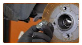
Entfernen Sie die an der Radnabenlagereinheit montierte Bremstrommel.
