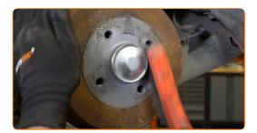
Behandeln Sie die Oberfläche, an der die Radfelge die Bremstrommel berührt. Verwenden Sie Keramikfett.
