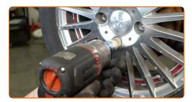
Senken Sie das Auto und ziehen Sie die Radschrauben über Kreuz an. Verwenden Sie eine Schlagnuss für Felgen # 17. Verwenden Sie einen Drehmomentschlüssel. Ziehen Sie ihn mit 110 Nm Drehmoment fest.
