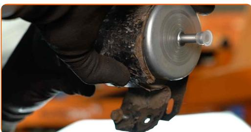
**15** Installieren Sie einen neuen Kraftstofffilter.
