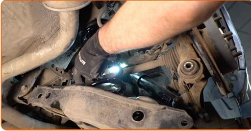
**32** Stützen Sie den Arm. Benutzen Sie einen hydraulischen Getriebeheber.
