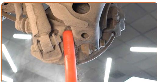
**7** Schrauben Sie den hinteren Querarmverschluss vom Achsschenkel ab. Verwenden Sie Stecknuss Nr. 17. Verwenden Sie ein Windeisen.
