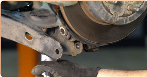
**33** Reinigen Sie die Montagebohrungen und die Gewinde des Querlenkers. Benutzen Sie eine Drahtbürste. Benutzen Sie WD-40-Spray.
