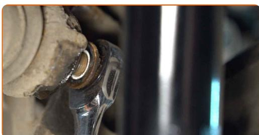
**16** Entfernen Sie die Befestigungsmutter.
