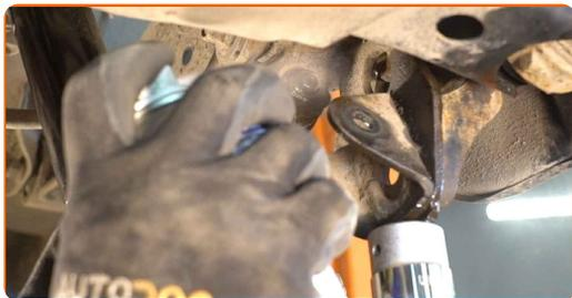
**15** Drehen Sie Befestigungselement auf, das den Querlenker mit dem hinteren Achsschenkel verbindet. Verwenden Sie Ring-Gabelschlüssel Nr. 17.
