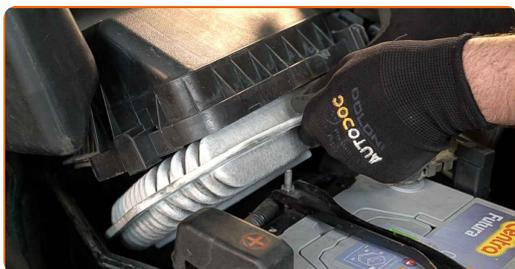
**6** Schrauben Sie die Halteklammer und Befestigungen am Ansaugrohr des Luftfilters ab. Verwenden Sie Stecknuss Nr. 10. Verwenden Sie einen Ratschenschlüssel.
