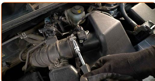
**7** Trennen Sie das Luftansaugrohr vom Luftfilter-Gehäuse.
