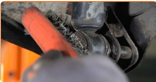
**11** Schrauben Sie den unteren Befestiger des Stoßdämpfers ab. Verwenden Sie Stecknuss Nr. 14. Verwenden Sie einen Ratschenschlüssel.
