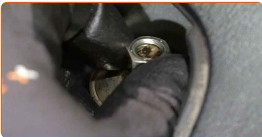
**15** Entfernen Sie die Elemente der oberen Befestigung des Stoßdämpfers.
