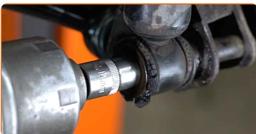
**12** Entfernen Sie die Befestigungsschraube.
