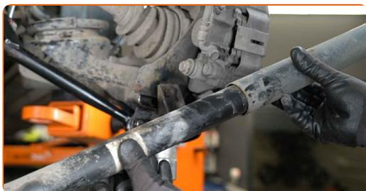
**18** Reinigen Sie die Stoßdämpferaufnahmen. Benutzen Sie eine Drahtbürste. Benutzen Sie WD-40-Spray.
