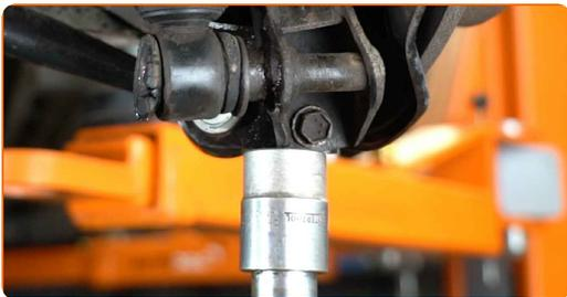
**14** Schrauben Sie das obere Befestigungselement des Stoßdämpfers ab.
