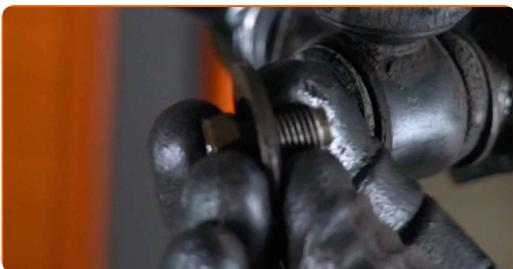
**13** Stützen Sie den hinteren Achsschenkel ab. Benutzen Sie einen hydraulischen Getriebeheber.
