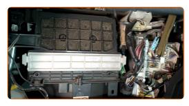
Entfernen Sie das Innenraumfiltergehäuse.
