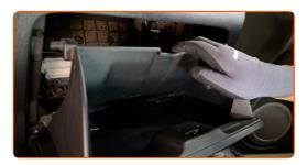
Drücken Sie auf die Halteclips des Pollenfilters, um sie zu lösen.
