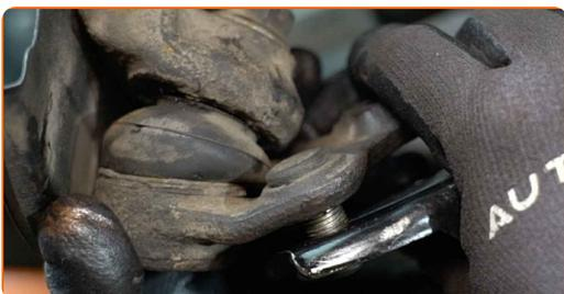
**56** Ziehen Sie die Befestigungen an, die das Kugelgelenk mit dem Achslenker verbinden. Verwenden Sie Stecknuss Nr. 17. Verwenden Sie einen Ratschenschlüssel.
