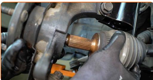
**55** Verbinden Sie das Kugelgelenk mit dem Lenker.
