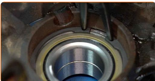
**49** Reinigen Sie den Einbauort für die Nabenlagerung. Benutzen Sie eine Drahtbürste. Benutzen Sie WD-40-Spray.
