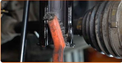
**39** Reinigen Sie die Befestigung des Spurstangenkopfes. Benutzen Sie eine Drahtbürste. Benutzen Sie WD-40-Spray.
