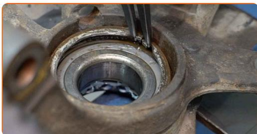
**44** Demontieren Sie den Lagerinnenring, der sich noch auf der Nabe befindet. Verwenden Sie einen Druckstücksatz mit Ein-/Auspresswerkzeug. Verwenden Sie ein ein Trennmesser für Lager.
