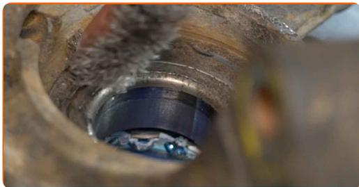
**43** Entfernen Sie den Sicherungsring am Radnabenlager. Verwenden Sie eine Sicherungsringzange.
