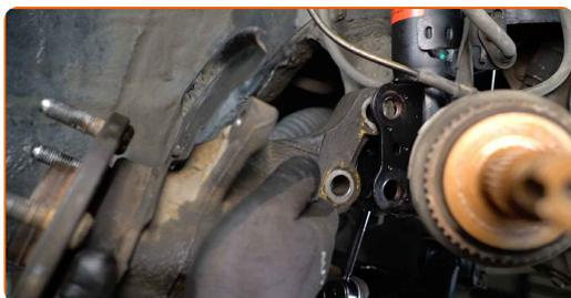
**52** Befestigen Sie das Dämpferbein auf dem Achsschenkel.
