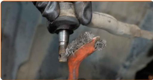
**40** Reinigen Sie die Befestigungen des Kugelgelenks. Benutzen Sie eine Drahtbürste. Benutzen Sie WD-40-Spray.
