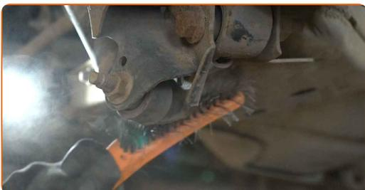
**7** Schrauben Sie das obere Befestigungselement des Stoßdämpfers ab. Verwenden Sie Stecknuss Nr. 16. Verwenden Sie einen Ratschenschlüssel.
