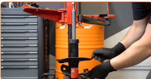
**39** Installieren Sie die Feder am Stoßdämpfer.
