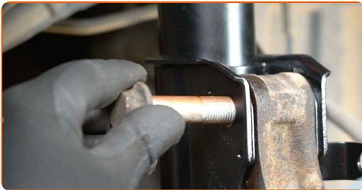
**53** Entfernen Sie den Träger unter dem Achsschenkel.
