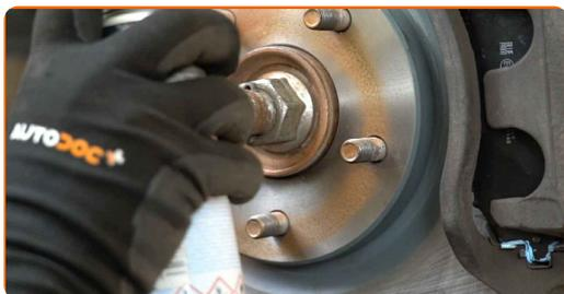
**64** Die Bremsscheibenoberfläche reinigen. Benutzen Sie einen Bremsenreiniger.
