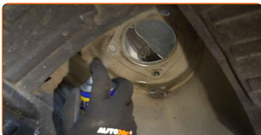
**47** Installieren Sie das Federbein am Radlauf.
