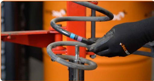
**37** Entnehmen Sie den alten Stoßdämpfer aus dem hydraulischen Spiralfederspanner.
