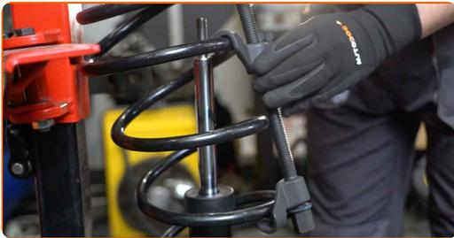
**41** Montieren Sie die Befestigung, die Manschette und den Stoßstopp am neuen Stoßdämpfer.
