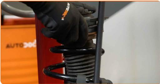
**42** Ziehen Sie die Federbeinkolbenstangenmutter an. Verwenden Sie Inbusschlüssel Nr. H6. Verwenden Sie Stecknuss Nr. 18. Verwenden Sie einen Drehmomentschlüssel. Ziehen Sie ihn mit 62 Nm Drehmoment fest.
