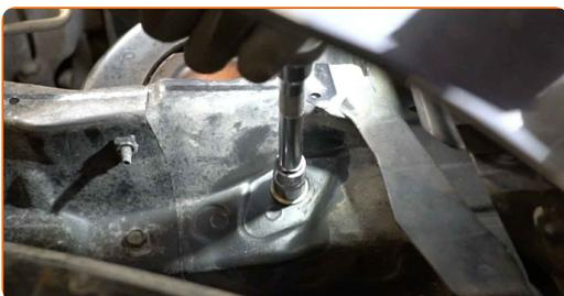
**70** Behandeln Sie die Befestigungselemente des Federbeinstützlagers. Benutzen Sie ein Kupferschmiermittel.
