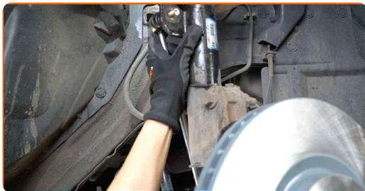
**12** Ziehen Sie das Befestigungselement an, das die Druckstange mit dem Stabilisator verbindet. Verwenden Sie Ring-Gabelschlüssel Nr. 19. Verwenden Sie Stecknuss Nr. 19. Verwenden Sie einen Drehmomentschlüssel. Ziehen Sie ihn mit 65 Nm Drehmoment fest.
