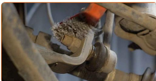
**7** Schrauben Sie das Befestigungselement heraus, das die Druckstange mit dem Federbein verbindet. Verwenden Sie Stecknuss Nr. 21. Verwenden Sie einen Ratschenschlüssel.
