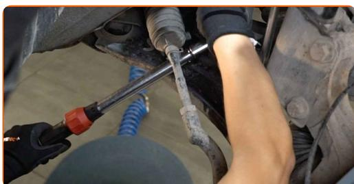
**13** Ziehen Sie das Befestigungselement an, das die Druckstange mit dem Federbein verbindet. Verwenden Sie Ring-Gabelschlüssel Nr. 19. Verwenden Sie Stecknuss Nr. 19. Verwenden Sie einen Drehmomentschlüssel. Ziehen Sie ihn mit 65 Nm Drehmoment fest.
