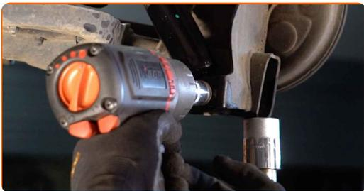
**9** Entfernen Sie die Befestigungsschraube.
