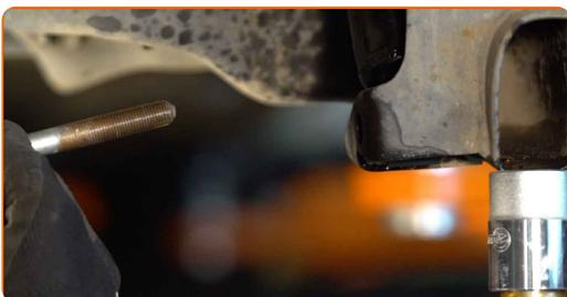
**10** Die Montage unter dem Hinterachsträger entfernen.
