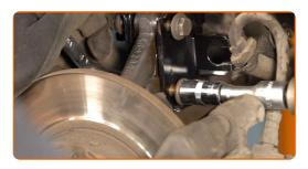
Ziehen Sie die unteren Befestigungen an, die das Federbein mit dem Achsschenkel verbinden. Verwenden Sie Stecknuss Nr. 15. Verwenden Sie Ring-Gabelschlüssel Nr. 17. Verwenden Sie einen Drehmomentschlüssel. Ziehen Sie ihn mit 75 Nm Drehmoment fest.
