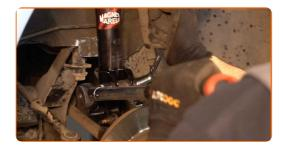
Befestigen Sie den Bremsschlauch an der Strebe.
