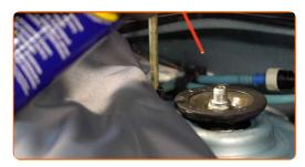
Lösen Sie die oberen Befestigungselemente des Federbeinstützlagers. Verwenden Sie Inbusschlüssel Nr. H6. Verwenden Sie Stecknuss Nr. 19. Verwenden Sie einen Ratschenschlüssel.
