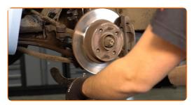
Entfernen Sie die Befestigungsschrauben. Benutzen Sie ein Brecheisen.
