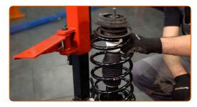
Installieren Sie das Federbein am Radlauf.
