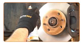
Die Bremsscheibenoberfläche reinigen. Benutzen Sie einen Bremsenreiniger. Austausch: Federbein – Fiat Punto 188. AUTODOC-Experten empfehlen: Warten Sie einige Minuten nachdem Sie das Spray aufgebracht haben.
