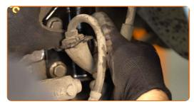
Ziehen Sie den Bremsschlauchhalter fest. Verwenden Sie Stecknuss Nr. 12. Verwenden Sie einen Ratschenschlüssel.
