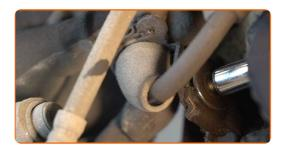
Lösen Sie den Bremsschlauch vom Federbein.
