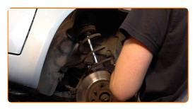
20 Stellen Sie das Dämpferbein auf das Federspannwerkzeug.
