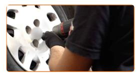
Senken Sie das Auto und ziehen Sie die Radschrauben über Kreuz an. Verwenden Sie einen Drehmomentschlüssel. Ziehen Sie ihn mit 86 Nm Drehmoment fest.
