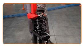
Entfernen Sie das zusammengebaute Federbein.
