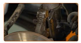
Lösen Sie die obere Befestigung der Federbeinbefestigung. Verwenden Sie Stecknuss Nr. 19.
