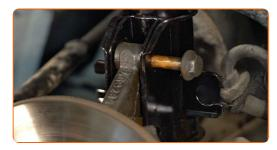
Entfernen Sie den Träger unter dem Achsschenkel.
