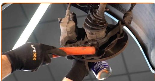
**17** Installieren Sie den Arm. Benutzen Sie ein Brecheisen.
