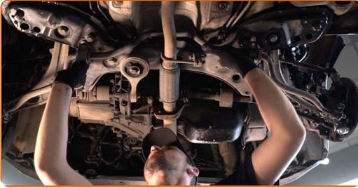
**26** Schrauben Sie das Befestigungselement der Halterung ein, die den Stabilisator mit der Karosserie verbindet. Verwenden Sie Stecknuss Nr. 13.
