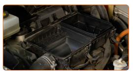
Setzen Sie ein neues Filterelement in das Filtergehäuse. Stellen Sie sicher, dass die Filterkante dicht am Gehäuse ansitzt.
