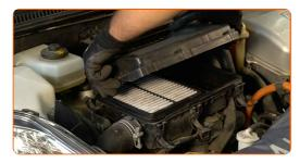
6 Entfernen Sie das Filterelement aus dem Filtergehäuse.
