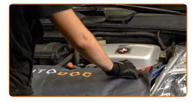
Lösen Sie die Befestigungsclips der Luftfilterabdeckung.
