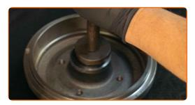
Installieren Sie die Nabenlagerhalterung und sichern Sie diese.
