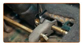
Lösen Sie den Hebel der Handbremse.
