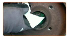
Entfernen Sie den Innenring des Radlagers von der Bremstrommel. Benutzen Sie einen dreiarmigen Abzieher. Verwenden Sie einen Druckstücksatz mit Ein-/Auspresswerkzeug.
