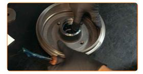
Installieren Sie die Nabenlagerhalterung und sichern Sie diese.
