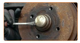
Entfernen Sie den Splint, der die Nabenmutter sichert. Benutzen Sie ein Brecheisen. Benutzen Sie einen Hammer.
