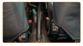
Lockern Sie das Feststellbremsseil. Verwenden Sie Ring-Gabelschlüssel Nr. 10.
