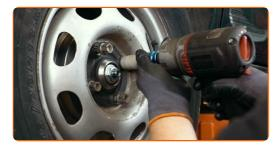
Schrauben Sie die Nabenmutter an. Verwenden Sie Stecknuss Nr. 24. Verwenden Sie einen Ratschenschlüssel.
