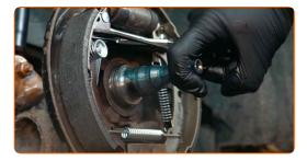
Bauen Sie die mit dem Radnabenlager zusammengesetzte Bremstrommel ein.
