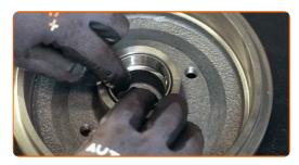
Setzen Sie den neuen Innenring des Radlagers in die Bremstrommel ein. Verwenden Sie einen Druckstücksatz mit Ein-/Auspresswerkzeug. Benutzen Sie einen Hammer.
