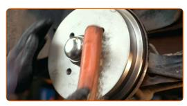
Behandeln Sie die Oberfläche, an der die Radfelge die Bremstrommel berührt. Benutzen Sie ein Kupferschmiermittel.
