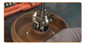
Entfernen Sie den Innenring des Radlagers von der Bremstrommel. Verwenden Sie einen Druckstücksatz mit Ein-/Auspresswerkzeug.
