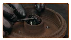
Reinigen Sie den Einbauort für die Nabenlagerung.
