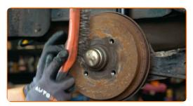
Entfernen Sie die Radnabenkappe. Benutzen Sie ein Brecheisen. Benutzen Sie einen Hammer.
