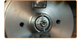
Installieren Sie die Kappe der Nabenmutter. Benutzen Sie einen Hammer.
