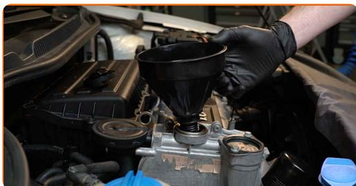
**22** Füllen Sie Öl durch den Einfüllstutzen in den Motor. Erforderliche Menge an Öl: 3.6 l.
