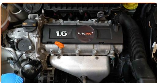
**27** Überprüfen Sie den Ölstand 5 Minuten nach dem Anhalten des Motors, verwenden Sie einen Peilstab und fügen Sie - wenn nötig - Öl hinzu.
