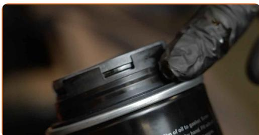
**15** Schrauben Sie den neuen Filter in seinen Platz. Verwenden Sie Steckschlüssel 76-14F. Verwenden Sie einen Drehmomentschlüssel. Ziehen Sie ihn mit 25 Nm Drehmoment fest.
