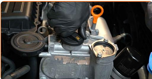
**26** Lassen Sie den Motor ein paar Minuten laufen. Nachdem die Ölstands-Warnleuchte erloschen ist, stoppen Sie den Motor.
