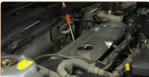
**4** Entfernen Sie die Motorabdeckung. Verwenden Sie einen flachen Schraubendreher.
