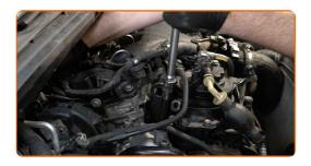
Schrauben Sie die Befestigungen, die das Motorlager mit der Karosserie verbinden, ein. Verwenden Sie Stecknuss Nr. E14. Verwenden Sie einen Ratschenschlüssel.
