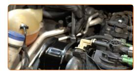
Schrauben Sie die Befestigungen, die das Motorlager mit der Karosserie verbinden, fest. Verwenden Sie Stecknuss Nr. E14. Verwenden Sie einen Drehmomentschlüssel. Ziehen Sie ihn mit 60 Nm Drehmoment fest.
