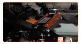
Reinigen Sie die Motorlager-Befestigungen. Benutzen Sie eine Drahtbürste. Benutzen Sie WD-40-Spray.
