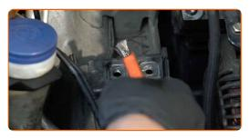
Behandeln Sie die Befestigungen des Motorlagers. Verwenden Sie ein Dichtmittel.
