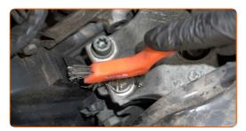
Schrauben Sie die Befestigungen, die das Motorlager mit der Karosserie verbinden, ab. Verwenden Sie Stecknuss Nr. E14. Verwenden Sie einen Ratschenschlüssel.
