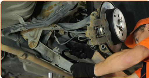
**19** Stützen Sie den hinteren Querlenker. Benutzen Sie einen hydraulischen Getriebeheber.
