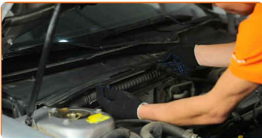
**4** Entfernen Sie das Filterelement aus dem Filtergehäuse. Verwenden Sie einen flachen Schraubendreher.
