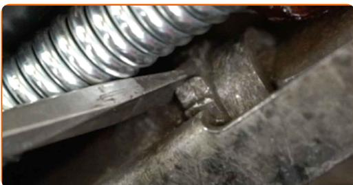
**15** Installieren Sie eine Bremstrommel.
