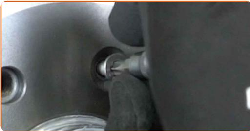
**17** Ziehen Sie die Bremstrommelbefestigungen an. Verwenden Sie den Torx T30. Verwenden Sie einen Drehmomentschlüssel. Ziehen Sie ihn mit 10 Nm Drehmoment fest.
