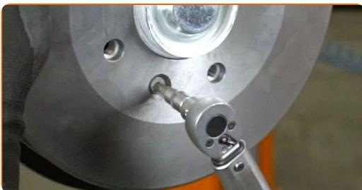
**18** Behandeln Sie die Oberfläche, an der die Radfelge die Bremstrommel berührt. Verwenden Sie Keramikfett.
