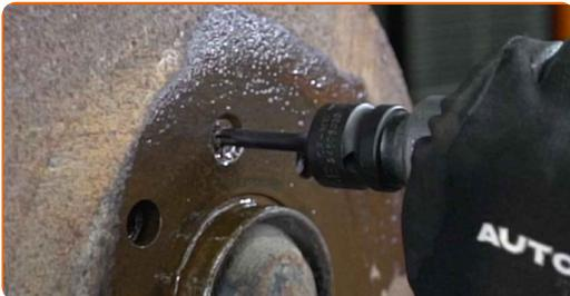
**8** Entfernen Sie die Befestigungsschrauben.
