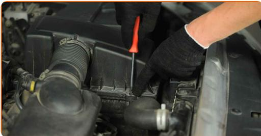
**4** Entfernen Sie die Abdeckung des Luftfilters.
