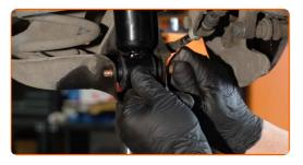
Ziehen Sie die obere Stoßdämpferbefestigung an. Verwenden Sie Stecknuss Nr. 13. Verwenden Sie einen Drehmomentschlüssel. Ziehen Sie ihn mit 45 Nm Drehmoment fest.
