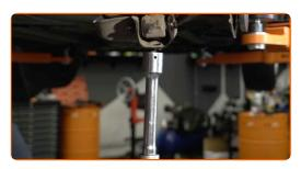
Schrauben Sie den unteren Befestiger des Stoßdämpfers ab. Verwenden Sie Ring-Gabelschlüssel Nr. 13. Verwenden Sie Stecknuss Nr. 15. Verwenden Sie einen Ratschenschlüssel.
