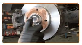
Die Bremsscheibenoberfläche reinigen. Benutzen Sie einen Bremsenreiniger.
