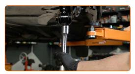
Ziehen Sie den unteren Befestiger des Stoßdämpfers an. Verwenden Sie Ring-Gabelschlüssel Nr. 13. Verwenden Sie Stecknuss Nr. 15. Verwenden Sie einen Drehmomentschlüssel. Ziehen Sie ihn mit 57 Nm Drehmoment fest.
