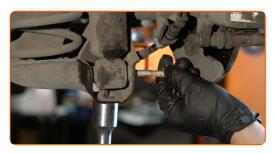
Den Stoßdämpfer entfernen.
