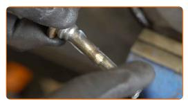
Setzen Sie die Halterung des Bremssattels ein.
