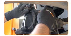
Befestigen Sie die Bremssattelhalterung. Verwenden Sie den Torx T55. Verwenden Sie einen Drehmomentschlüssel. Ziehen Sie ihn mit 105 Nm Drehmoment fest.
