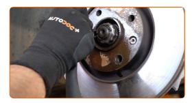
Entfernen Sie die Bremsscheibe. 17
