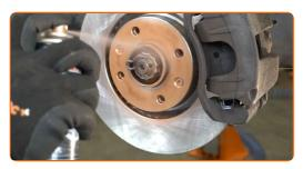
Die Bremsscheibenoberfläche reinigen. Benutzen Sie einen Bremsenreiniger.
