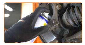
Lösen Sie die Befestigung der Sattelhalterung. Verwenden Sie den Torx T55. Verwenden Sie ein Windeisen. Verwenden Sie einen Ratschenschlüssel.
