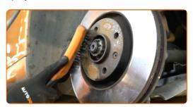
Lösen Sie die Befestigung der Bremsscheibe. Verwenden Sie den Torx T30. Verwenden Sie einen 16 Schlagschrauber.
