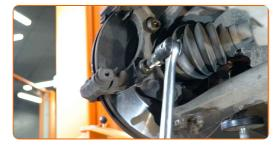
14 Entfernen Sie die Sattelhalterung.
