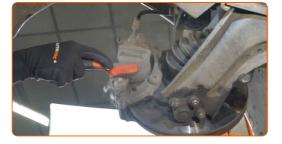
Schrauben Sie die Befestigung des Bremssattels ab. Verwenden Sie Ring-Gabelschlüssel Nr. 13.
